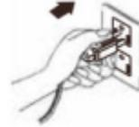
1.2. Vérifiez que le réservoir de condensats est correctement inséré dans le déshumidificateur. (Le voyant "Réservoir de condensat plein" peut s'allumer lors de la mise en service. Il suffit de retirer brièvement le réservoir de condensats, puis de le remettre en place pour être prêt à démarrer).
